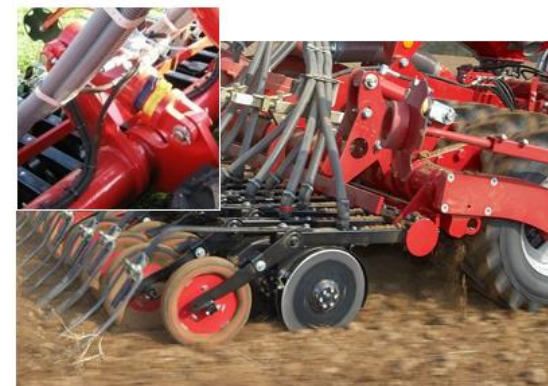
Высевающая балка+ регулирование рабочей глубины Pronto 3 - 6 DC
